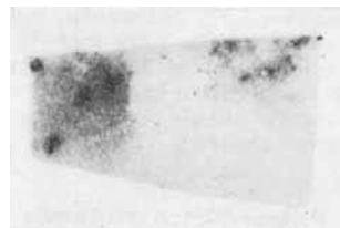
Abb. 3. Autoradiogramm eines Anthracen-Kristalls, dessen linke Hälfte auf photochemischem Wege oberflächlich oxydiert ist. Die Oberfläche war mit einer Lithium-Schicht bedeckt und mit Neutronen bestrahlt worden. Man erkennt auf der linken Hälfte die Schwärzung der Photoplate durch 18 F. Die Schwärzungen auf der nicht anoxydierten Hälfte stammen von der Strahlung sonstiger im Kristall entstandener Nuklide
